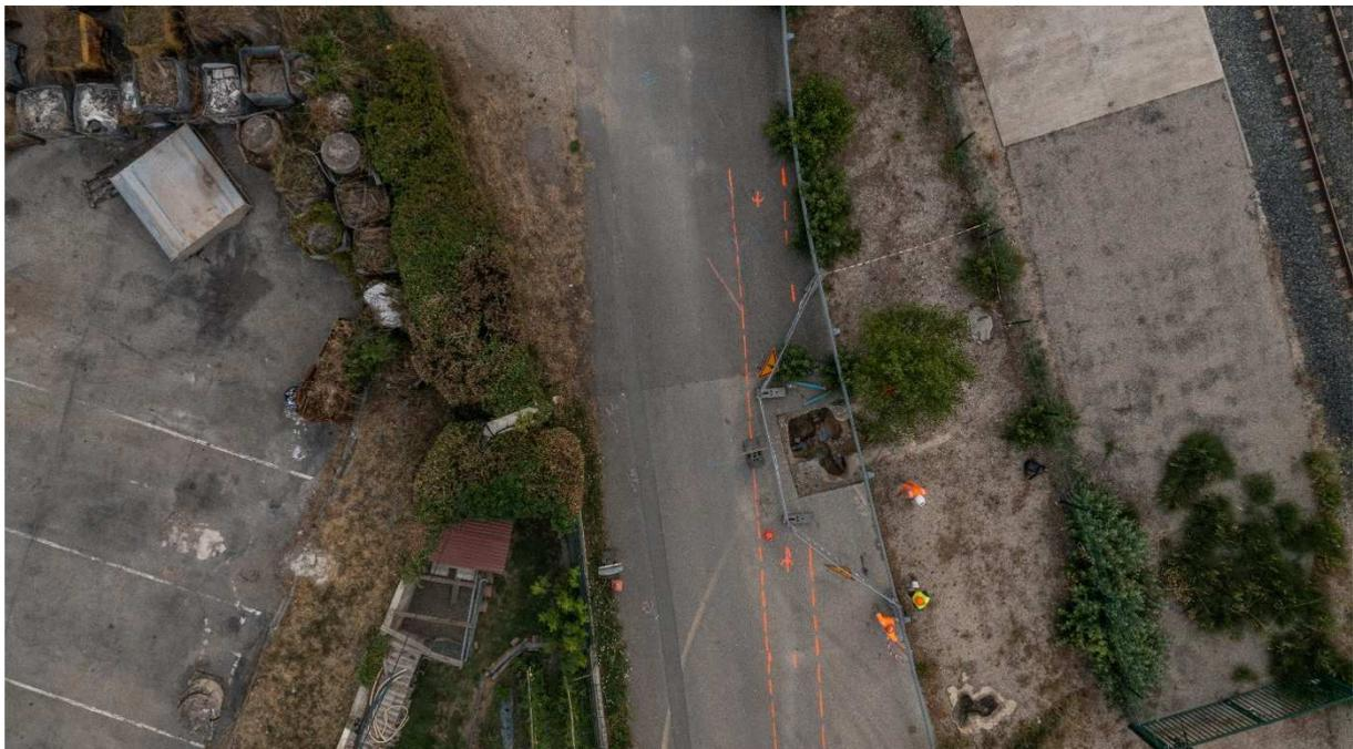
*Photo 3 : vue au drone d'un sondage pour contrôler la nature réelle du sous-sol et son encombrement et marquage piquetage de la canalisation projetée*
